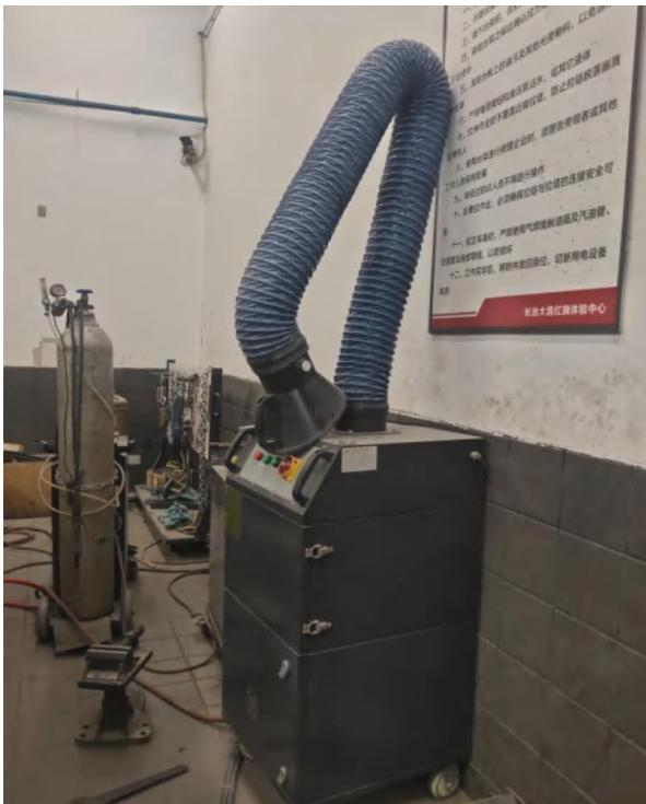
移动式双臂焊接烟尘净化器
